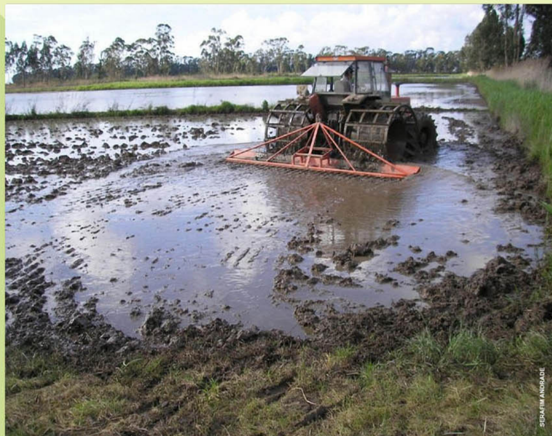
Przygotowanie ziemi: mechaniczne poziomowanie Nivelamento mecânico com grade espanhola e rodas arrozieras
