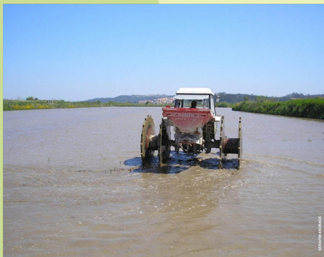
Siew ryz Sementeira do arroz com distribuidor centrífugo
